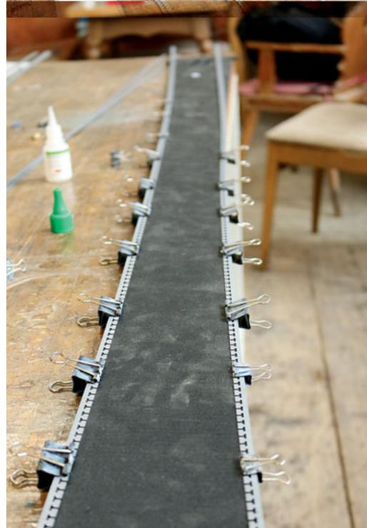
● Mit Superkleber und Klammern wird die Kante auf der Lauffläche befestigt.
